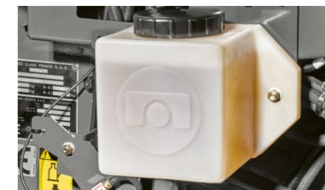
Lubrification permanente des chaînes.
